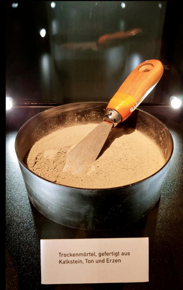
Trockenmörtel, gefertigt aus Kalkstein, Ton und Erzen
